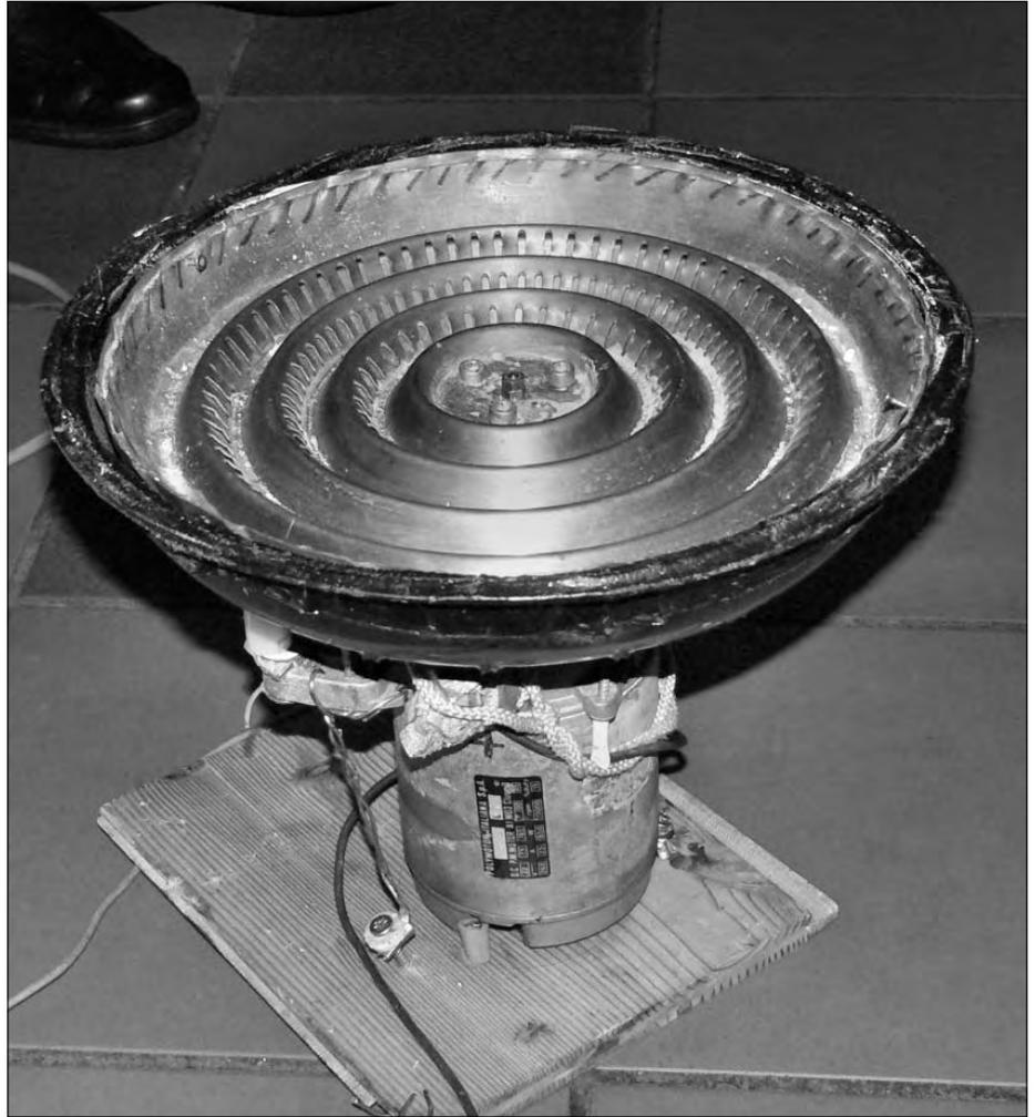
Bild 3: Scheibe nach dem Schauberger-Prinzip zur Klimatisierung eines Raumes. Die Scheibe wird mit einem Gleichstrommotor gedreht und erzeugt dabei einen warmen Luftstrom. Der Gleichstrommotor wird über einen Akku mit Solarenergie betrieben.
